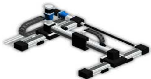
Рисунок 3 – система двухкоординатного позиционирования.
