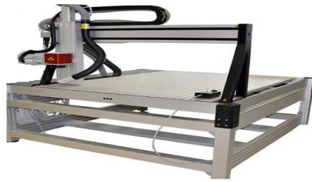
Рисунок 4 - лазерный станок с портальной трехкоординатной системой позиционирования.
